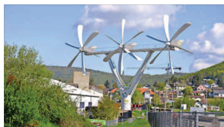
Das Kleinwindrad «Hans» läuft in Beringen SH in einer Testphase, da bei dem Pilotprojekt kurz nach Inbetriebnahme ein Rotorblatt abgebrochen ist. (Bild: Thomas Güntert)
