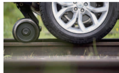
Der Land Rover Discovery Sport wurde bloss mit Schienenrädern ergänzt. Bild: zVg
